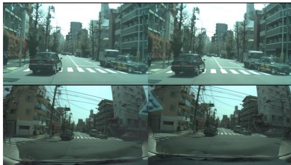
計測例 (上:望遠部左右画像 下:広角部左右画像)
